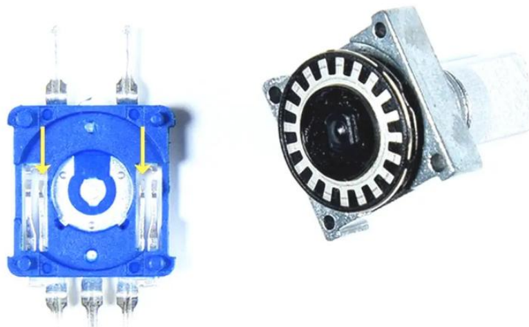
شکل ۴-۲۰- ساختار داخلی یک روتاری انکودر ولومی
