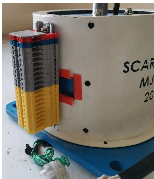
شکل ۳-۱۹- ترمینال های سیگنال، قدرت و تغذیه ربات اسکارا
