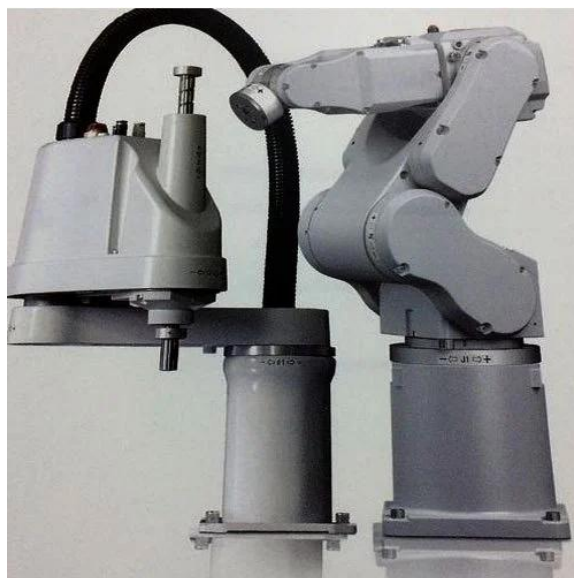
شکل ۲-۹- تفاوت ربات اسکارا با سایر انواع ربات‌ها
