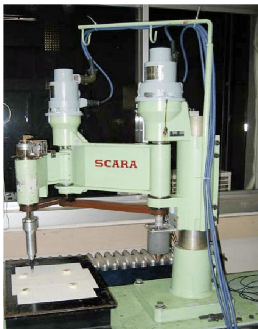
شکل ۲-۴ - یکی از نمونه‌های اولیه ربات اسکارا
