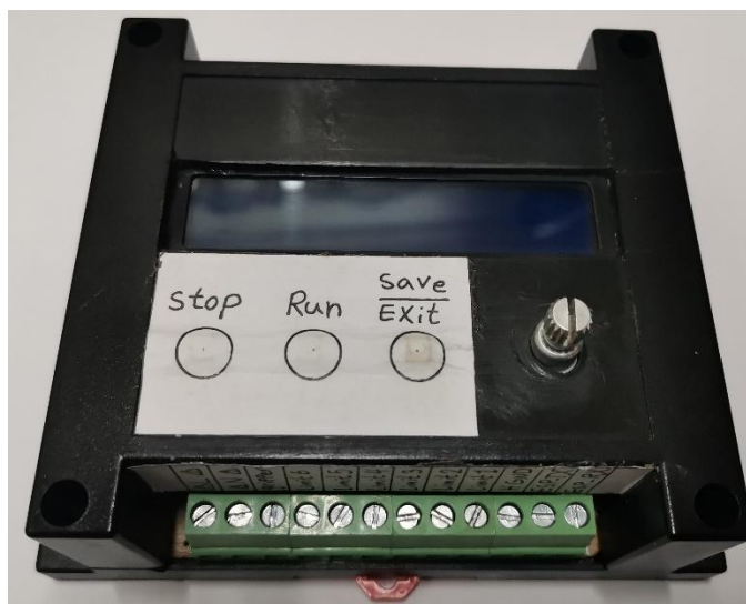
شکل ۴-۱- نمونه اولیه کنترلر ربات اسکارا
