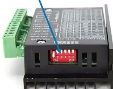
شکل ۳-۱۴- تنظیم حد جریان مصرفی استپر موتور
