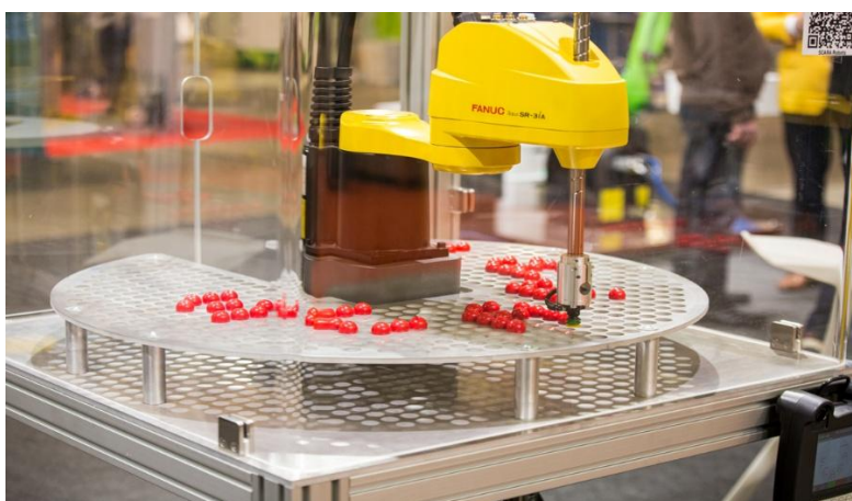
شکل ۲-۶- فرآیند انتخاب و جابجایی توسط ربات اسکارا
