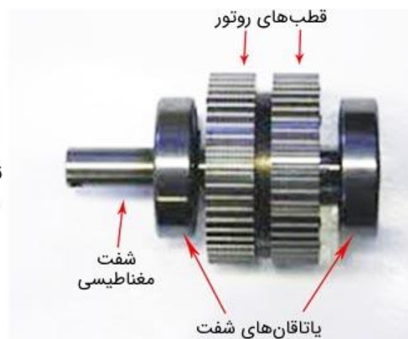
شکل ۳-۳- ساختار داخلی استپر موتور
